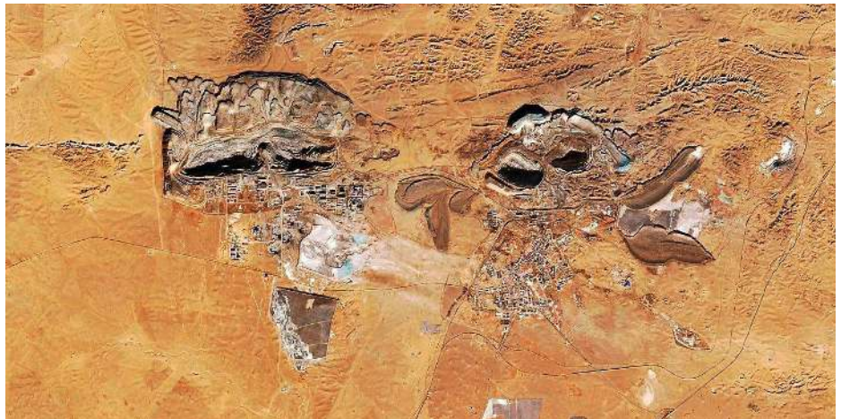
Die Bayan-Obo-Mine in der Provinz Innere Mongolei: als Nebenprodukt von Eisenerz werden dort 69.400 t Seltenerd-Oxide pro Jahr gefördert (32% der Weltproduktion). 16 Sentinel Hub, CC BY 3.0
